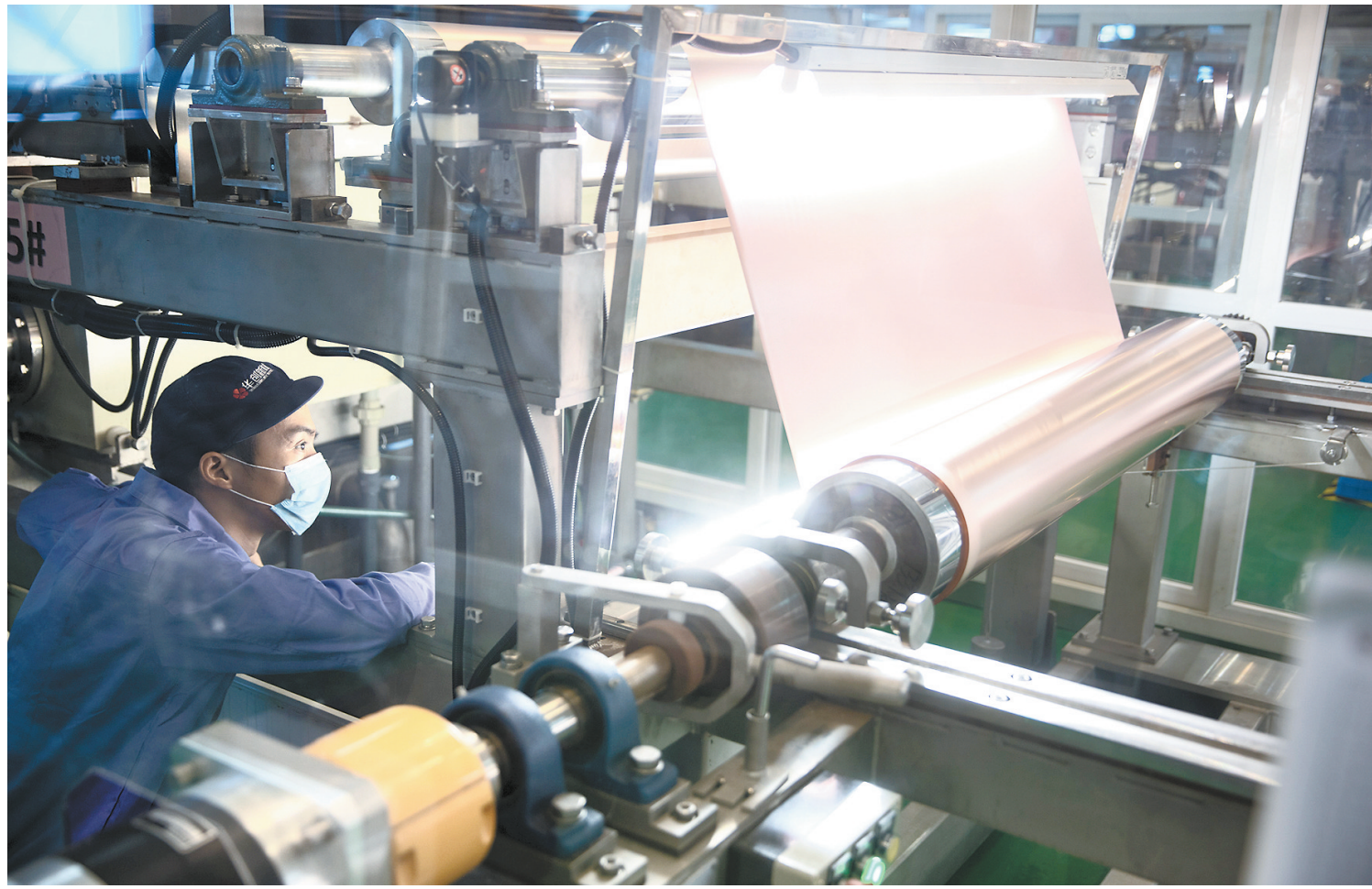
在安徽省铜陵市华创新材料有限公司生产车间，一名员工在监测锂电铜箔生产过程。
