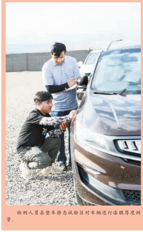
检测人员在整车静态试验区对车辆进行漆膜厚度测量。
