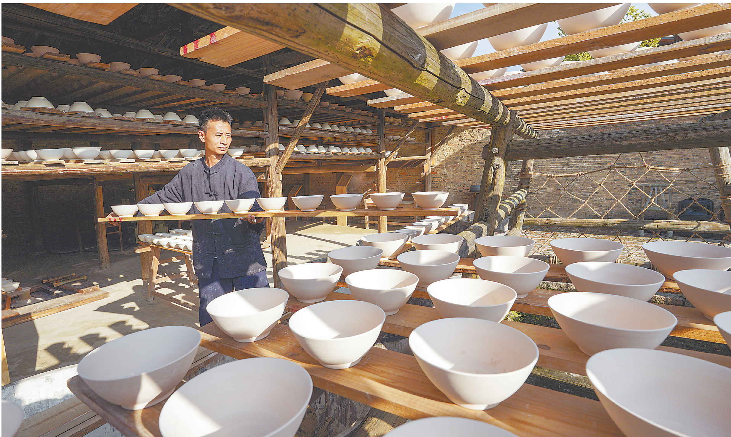
10月11日，在景德镇陶阳里历史文化街区明清窑作营造技艺长廊，工匠正在晾坯。江西日报全媒体记者 史港泽摄
