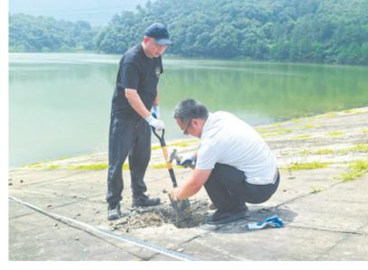
日前,省地质局第三大队对濂溪区赛阳镇南城乡水库实施科学土壤采样检测,开展大坝渗水问题“诊断”。此次工作科学布点,在大坝内倒约4000平方米范围内精准设置18个采样点位。工作人员严格遵循水利工程土壤检测规范,使用专业工具采集代表性样品,确保数据真实可靠,为后续分析提供坚实基础。采样检测的核心目标是查明大坝渗水根源。通过对18份土壤样品的专业分析,将为水利设计院提供关键试验数据,辅助判断渗水是否与大坝内倒土质特性相关,进而为制定精准防渗修复方案提供科学依据。(廖柳 摄)
